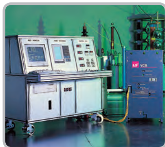
Проверка характеристик вакуумного автоматического выключателя
