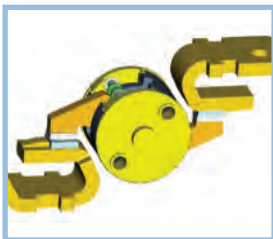
Оптимизированная форма эксцентрика
